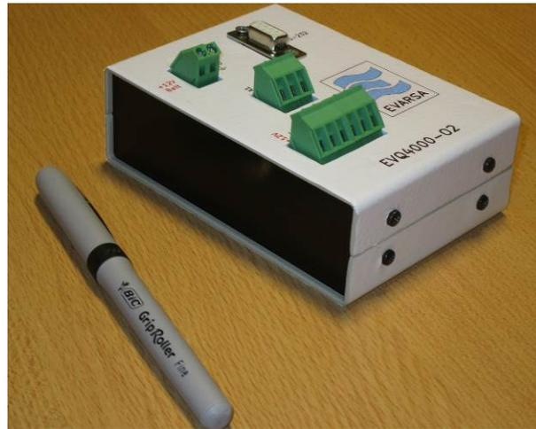
Figura 1.- Datalogger y transmisor EVQ4000-O2
