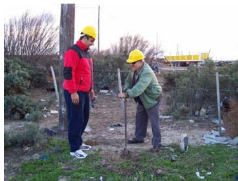
Foto 7.1.1.a Uso de barrena manual
