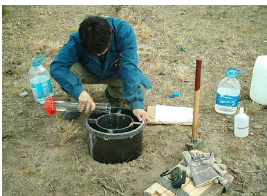
Fig. Instrumento hincado Comienzo del ensayo
