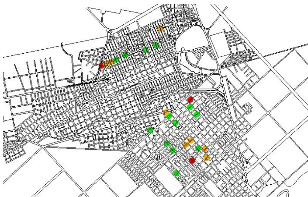
Fig. 3.5.4.b. Plano de la ciudad de Trelew con ilustración de los registros de sustancias solubles en éter etílico (grasas) en distintos puntos de la red cloacal.
