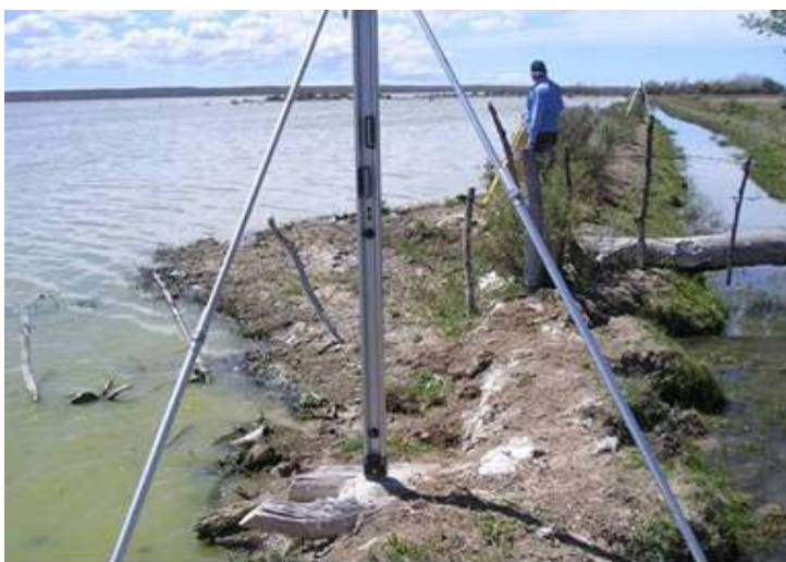
Foto 11.1.1.e Detalle del trabajo de transporte de cota.
