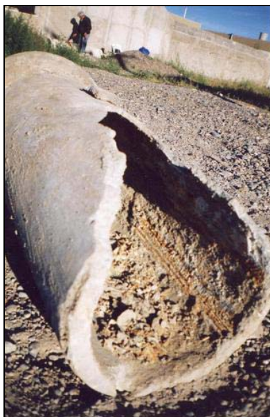
Foto II.5.7.3.a - Colectora Colapsada
